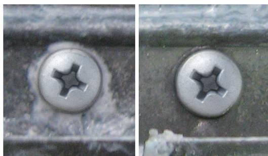
樹脂系トップコートの絶縁効果、2層目に一般的な亜鉛めっき鋼板と同種の合金コーティングを施すW効果で、電位差を極めて小さくしております。これまでのステンレス (SUS410) 材のねじを亜鉛めっき鋼板に使用した場合に発生していた電食の問題を解消しました。
