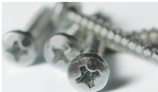
下地に強固な合金めっき(一般的な亜鉛めっき下地のおよそ3~4倍の硬さ)を加工することで、ドリルねじ・タッピングねじの長年の問題であった、ねじ込み時にめっきが剥がれ、素地が露出することにより短期間で腐食が発生する問題を解消しました。
