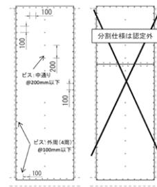
ボード厚 15mm仕様(枠組壁工法のみ)
