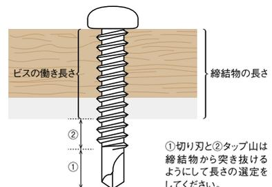
①切り刃と②タップ山は締結物から突き抜けるようにして長さの選定をしてください。
