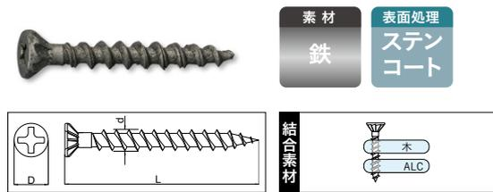
**特長** 従来品に比較して絶大な保持力が得られ(当社比)、ALCと木材との間に空隙ができるのを抑えます。また、市販のスクレイドライバーでねじ込みが可能(叩き込む方法と違いALCの損傷が少ない)、仮止めや下穴開けが不要です。ベニヤ・合板の重ね合わせにも威力を発揮し、大きな頭部で押さえを効かせます。特殊鋼総焼き入れを採用し、繰り返し使える強度を確保しました。また、独自のステンコート処理により防錆力にも優れます。
